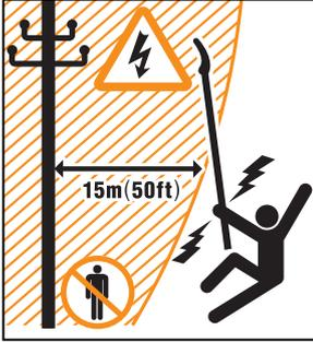
**خطر!** منشار القطب هذا يقوم بتوصيل الكهرباء. لا يستخدم في حدود 15 متر من الأسلاك الكهربائية أو خطوط طاقة محتملة أو أعراض على الأرض أو موصلات لخطر الإصابة الشديدة أو الموت عن طريق الصعق الكهربائي
