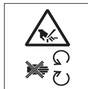
NEBEZPEČÍ – rotující nože. Je-li stroj v chodu, udržujte ruce a nohy mimo otvory drtiče.
